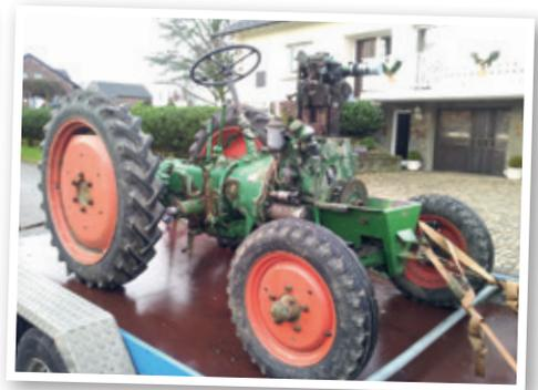
melt und mit dem Vater besprochen. Zahlen und Daten von Angeboten hatten auf einmal eine große Aussagekraft. Schließlich gab und gibt es ja die verschiedenen Typen der Modellreihe FL 514. Der Deutz F1 L 514 war der erste luftgekühlte Schlepper aus dem Hause Deutz und ersetzte den wassergekühlten F1 M 414. Er wurde ab 1950 gebaut und hatte einen 15 PS starken 1 Zylinder Motor sowie das 4-Gang Getriebe aus dem wassergekühlten 11-
